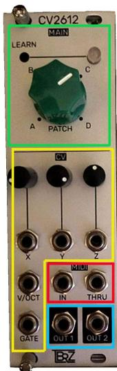
**MAIN** - Cuatro patches con interpolación de sus parámetros que se pueden editar con su propio software: <https://cv2612.netlify.app/> y un botón de Learn con el que seleccionamos el Play Mode
